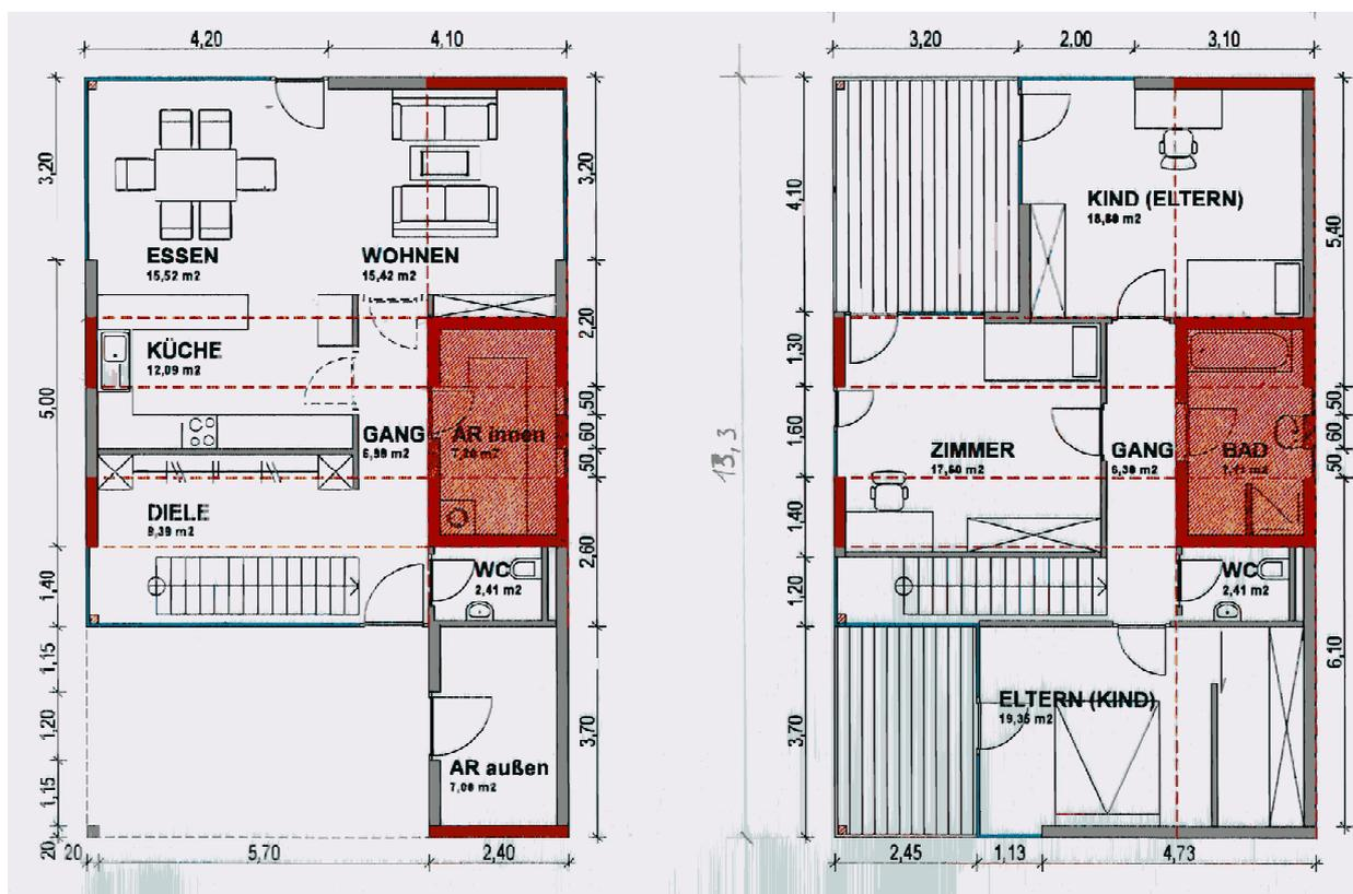
Abbildung: Grundrisse: Die roten Wände stellen die aussteifenden Wände dar. Die strichlinierten roten Deckenelemente stellen die steifen Deckenelemente (Hauptstruktur) dar.
