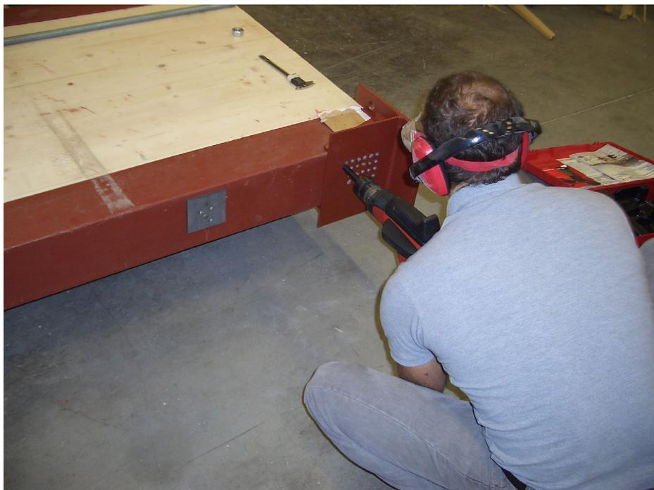
Abbildung: Befestigung der Stahlschuhe auf den „Verbundprüfkörper“ für zyklische Versuche mittels Hilti-Nägeln.
